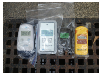
側溝の上を4台の放射線量測定器で測定
